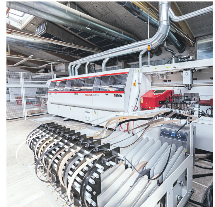
Neu bei Wettstein – die innovative Kantenanleimmaschine mit energieeffizientem Laserverfahren
